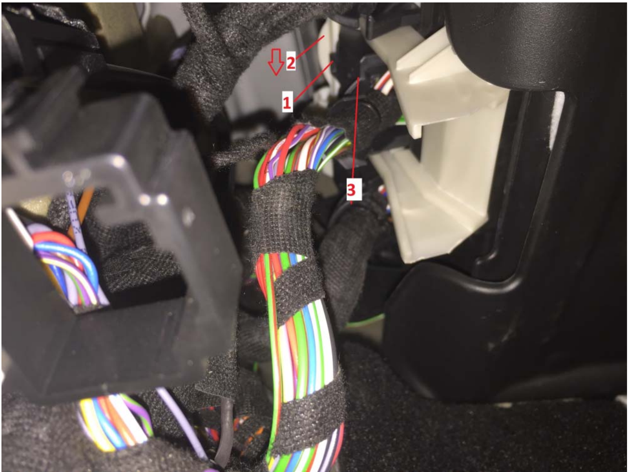
Kabel an Bordnetzsteuergerät
